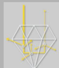
In einem unreinen Diamanten wird das Licht gestreut. Der Diamant funkelt weniger.
